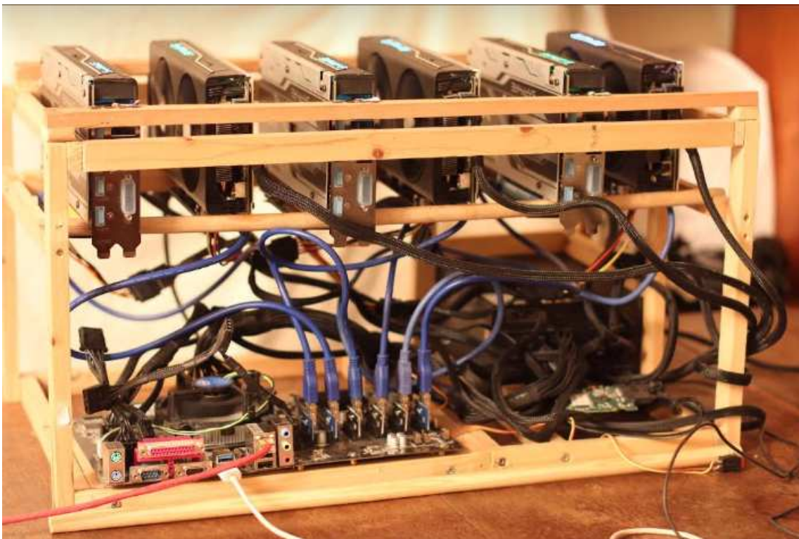
Una delle strutture utilizzate per il mining costituita da schede video poste in serie
